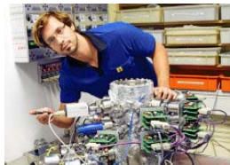
Industrie-Elektroniker Johannes Eisenberg beim Kalibrieren von Vakuum-Messtechnik. Foto: Michael Groß
